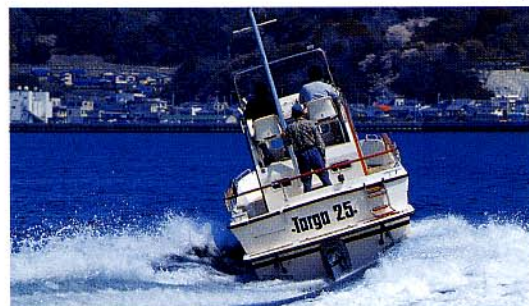
中庸なデッドライズに合わせるように、中庸な内傾をするという雰囲気。その気になればもっと切り込むこともできます。けっこう運動性の良いフネです
