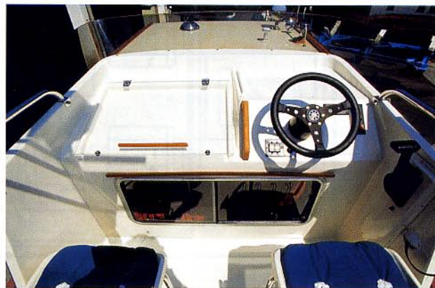
パイロットハウス内部を後方 から。チークの“箱モノ”やトリ ミング、さらにはチークのグラ ブハンドルなどがいい味を出 しています。インストパネルに は航法機器スペースがありま せんが、天井部分にはそれら 機器の取り付けスペースが用 意されます
