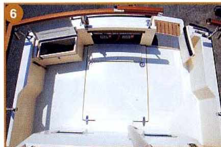
6 船尾側はエンジンルームの存在のために床位置が浅く、深さは38cm程度ですが、それをカバーすべく約30cmのスターンレールが立ち上げてあります。右舷に設けられた物入れ(兼腰掛け)はオプション
