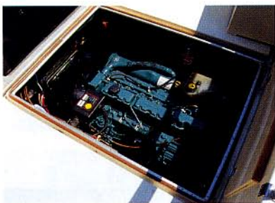
試乗艇はボルボのAD41P/DPを搭載。パワーは十分です。フネのコストや燃費の面から考えても、バランスのとれた選択といえるでしょう。ただ整備性の面から、エンジン周りにはもう少し余裕がほしいところ
