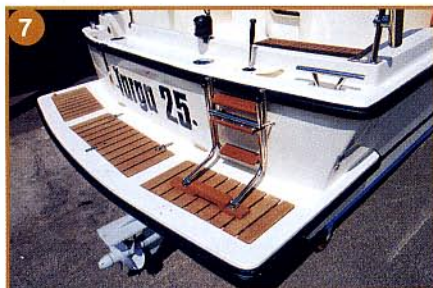
7 船尾には一部チーク仕上げのしっかりとしたスイムプラットフォームを装備。トランサム上の絨線上部に差し込んであるレバーは手動ビルジポンプのもので、これもまた北欧艇の定番装備というところです
