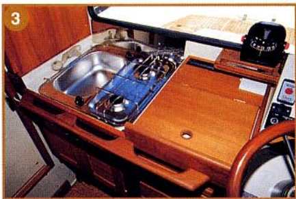
3 ハウス前方のカウンター部分、左舷側の天板を開くと、2口コンロとシンクで構成されたギャレユニットが内蔵されています。なおパンフレットに記された仕様によると、このギャレユニットはオプションとのこと
