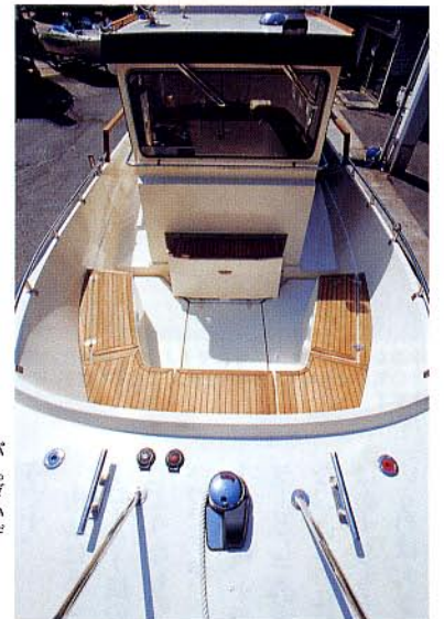
船首側から見ると、まさに箱型というパイロットハウスの形状がよく分かります。フロントウィンドウにはしっかりとしたダブルアームの2連ワイパーが付いていて、こういったところはけっこうヘビーデューティ
