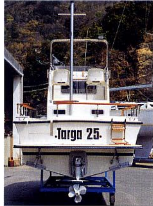
トランサムデッドライズは16~17度。ストレートなV型船型です。船尾に至っても舷側上部にフレアーが付いていることに注目
