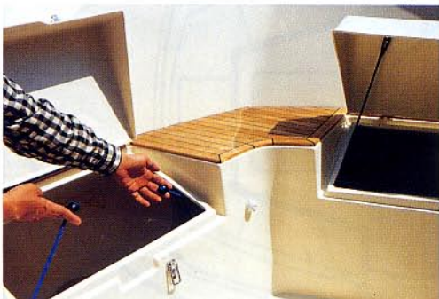
船首両舷の物入れハッチにはそれぞれを内部で引っ張る紐が付いて おり、その末端を船首中央の物入れにリード。それぞれの紐を引 て固定し、最後に中央の物入れを施錠すれば全部のハッチが施錠さ れる、という理屈です
