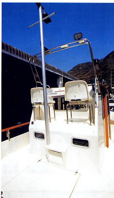
船尾側から見たハウス後部。フライブリッジへのス テップを避ける意味もあって、マストはわずかに左舷 側にオフセットされています。このマストにブームを 取り付けてデリッククレーンとする仕様も用意されて います
