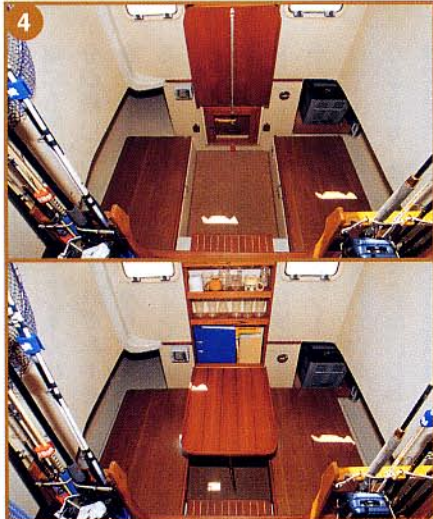
4 ハウス後部は大きく床位置を下げて天井高を確保した居住スペース。試乗艇はオーナーの意向でクッションを装備していませんが、両舷にセティ、中央に後部キャビネットの扉を兼ねたテーブルというスタイルです
