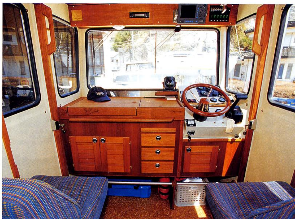
パイロットハウス内部を後方 から。チークの“箱モノ”やトリ ミング、さらにはチークのグラ ブハンドルなどがいい味を出 しています。インストパネルに は航法機器スペースがありま せんが、天井部分にはそれら 機器の取り付けスペースが用 意されます
