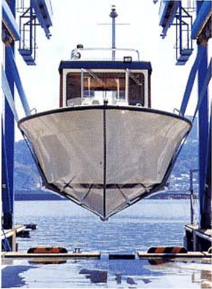
船首の上部にはかなり明確なフレアーが付いています。波浪中の航走では、このフレアーが最終的な船首揚力として役立ってくれることでしょう
